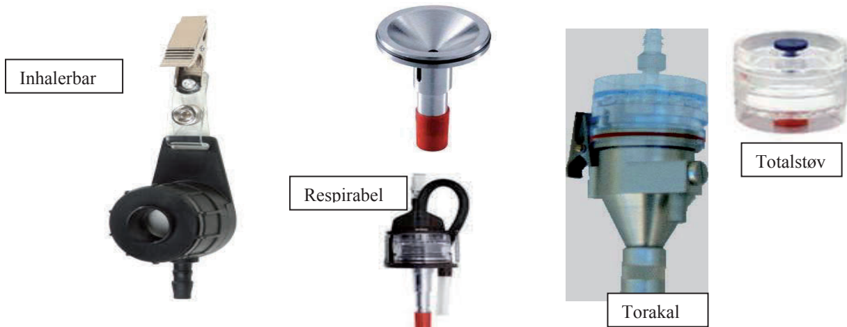
Figur 34 Prøvetakingskassetter for ulike støvfraksjoner
