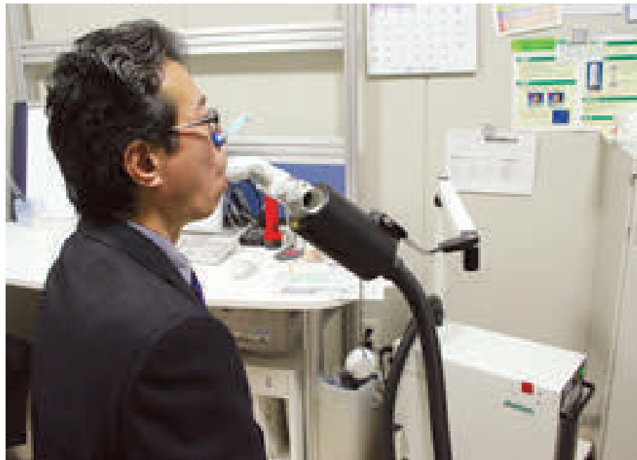
Figur 55 Oppsamling av pusteluftkondensat (EBC)
