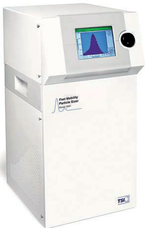
Figur 43 Måleinstrument for ultrafine partikler
