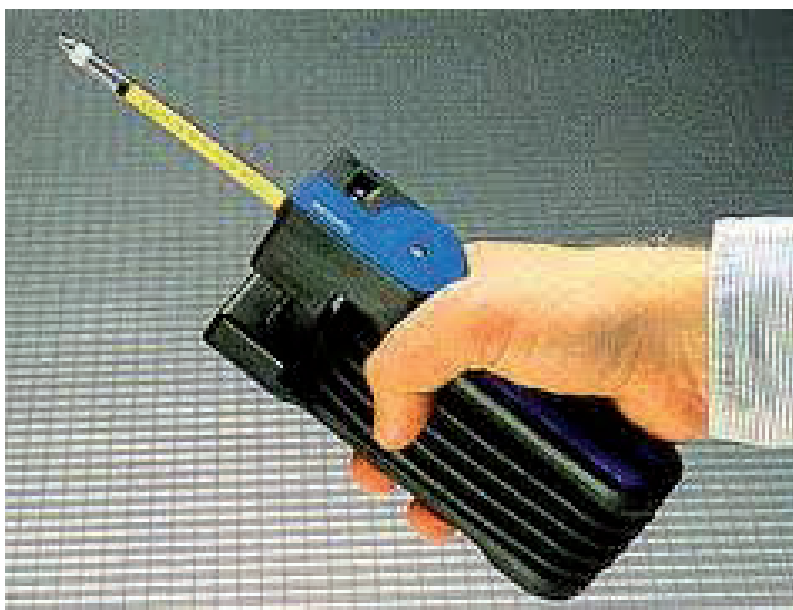
Figur 28 Gassmåling med fargeindikatorrør
